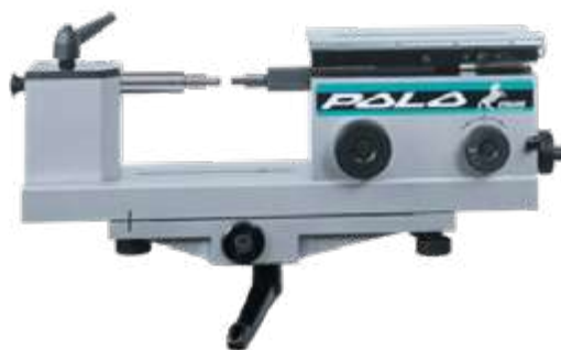
Banc TESA Etalon Polo, précision 0.00025 \mu\text{m}
